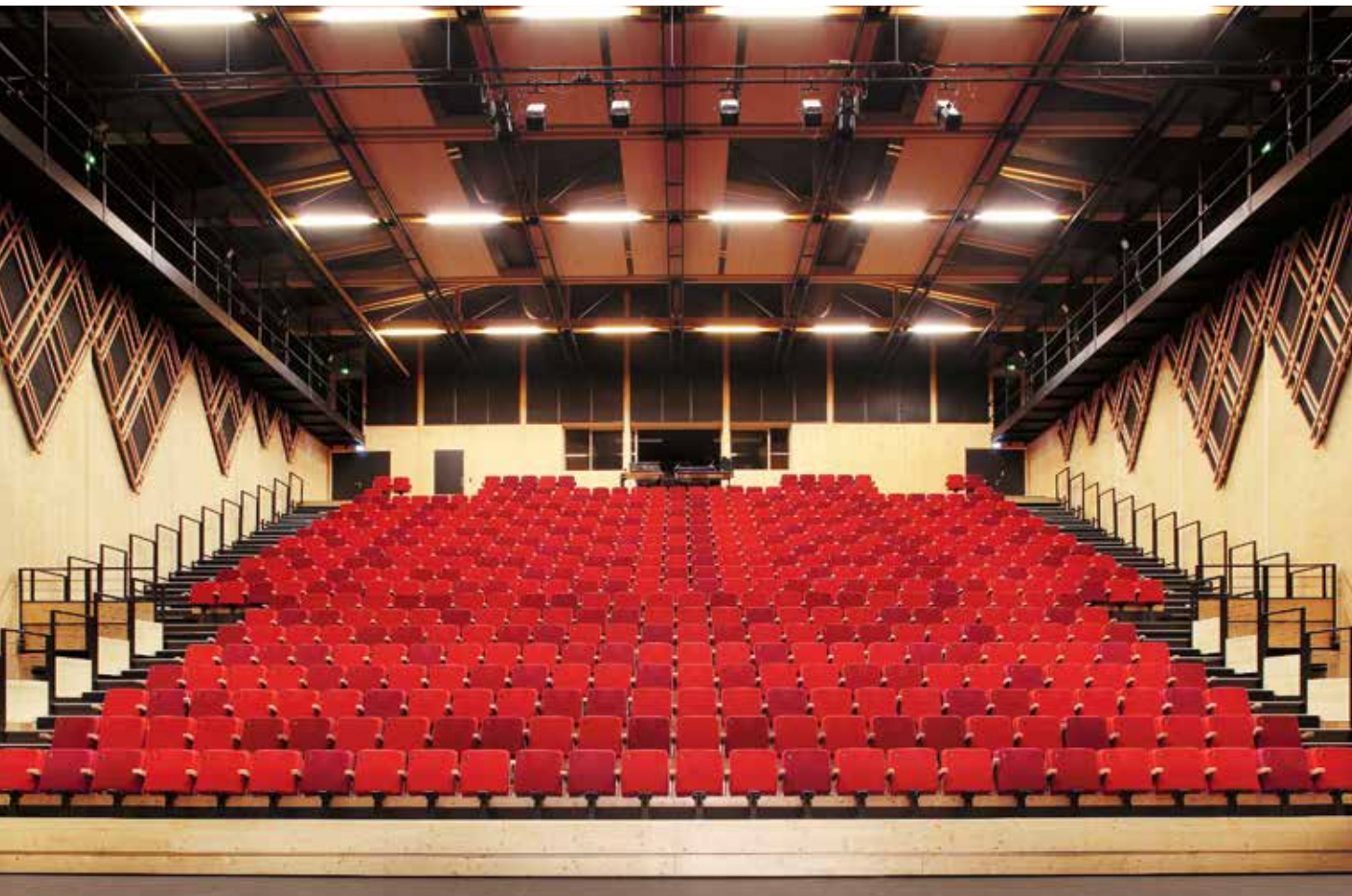
Teatern är 70 meter lång, 22,3 meter bred och 13,2 meter hög och rymmer totalt 1 800 åskådare, varav 1 200 på ståplats och 600 på sittplats. De vridna väggpanelerna framhäver scenljud och minskar ovälkomna ekon.
